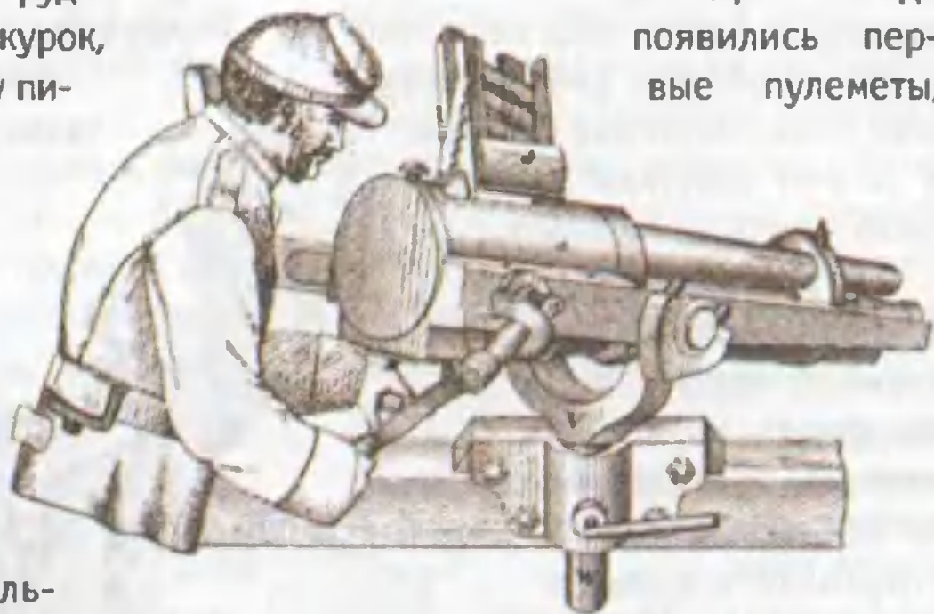
Пятиствольная морская пушка системы Гочкиса.
